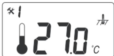
Pour vérifier la température effective mesurée, appuyer sur le bouton de confirmation pendant 6 secondes pour accéder au menu 1.
