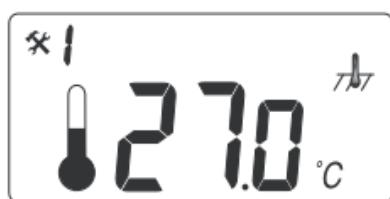
Zum Prüfen der gemessenen Ist-Temperatur drücken Sie die Bestätigungstaste 6 Sek. Lang. Im Menü Nummer 1 wird der gemessene Temperaturwert auf dem Display angezeigt:
