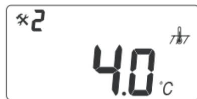
После стабилизации температуры пола. Значение уставочной температуры может быть откалибровано по отношению к реальной температуре пола/воздуха.
