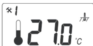
Tarkista anturilla mitatut lämpötilat painamalla <
