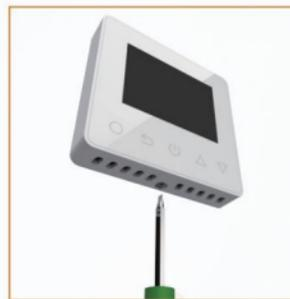
**Schritt 1:** Lösen Sie die Befestigungsschraube an der Unterseite des Thermostats, um an die Frontplatte zu gelangen.
