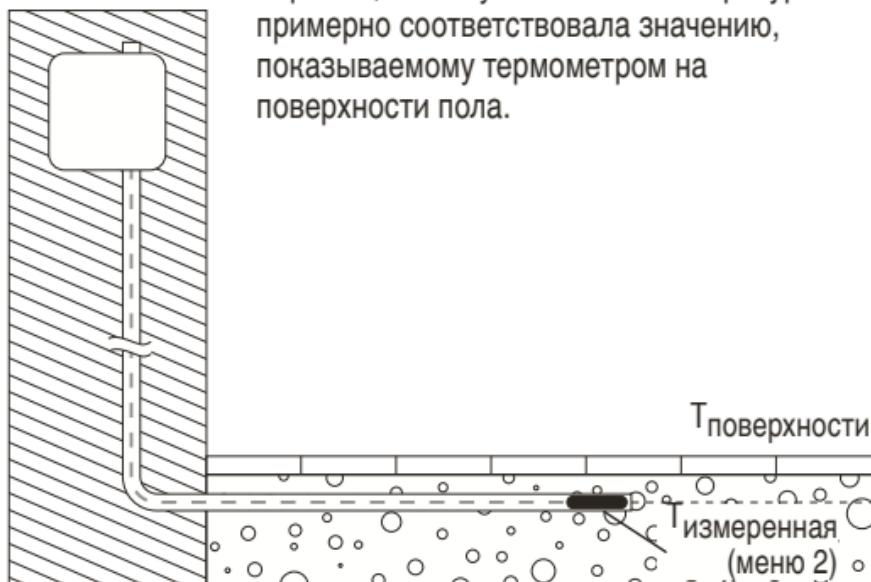
Температурный дифференциал =  $T_{\text{измеренная}} \text{ (меню 1)} - T_{\text{поверхности}}$
